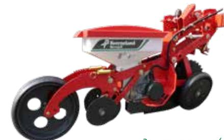
Электропривод (e-drive II) и прикатывающий каток Monoflex
