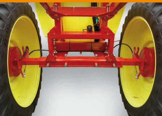
Регулируемая по ширине ось (iXtrack A)
