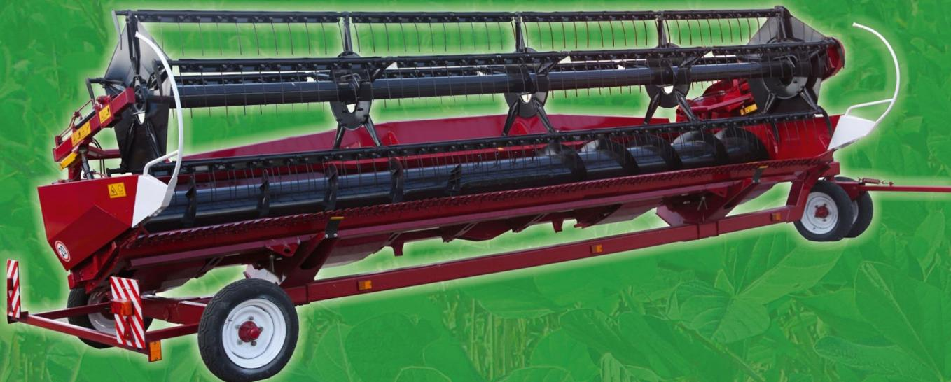
Жатка ЖЗС предназначена для уборки сои и зерновых колосовых культур. Жатка используется в составе комбайнов зерноуборочных самоходных КЗС-7, КЗС-812, КЗС-10К, КЗС-1218. Жатка для уборки сои унифицирована с серийными зерновыми жатками.
