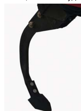
Стрельчатая лапа 100 мм — для рыхления почвы на глубину до 15 см, подрезания сорняков, сева строчкой, внесения удобрений
