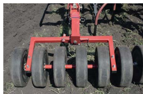
Прикатывающие катки 80 или 120 мм. Давление 130 кг на каток = 10 кг/см
