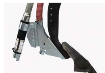
Сошник для двойного высева с двойным отводом для создания борозды и укладки удобрения и семян на разных уровнях
