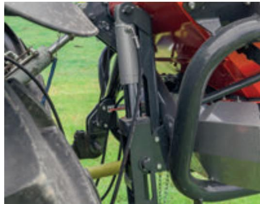
Разбрасывание по краю с помощью колеечного цилиндра - разбрасывание в направлении к краю из последней технической колеи
