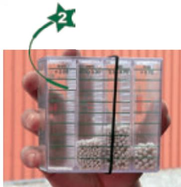
2 Определите размер и распределение гранул
