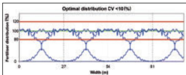
КВ < 10% означает оптимальную схему разбрасывания
