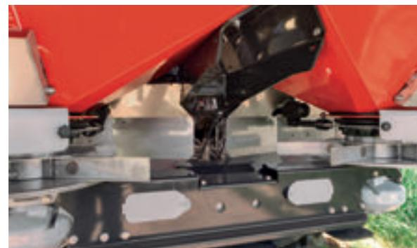
Один электрический привод для регулирования нормы внесения
