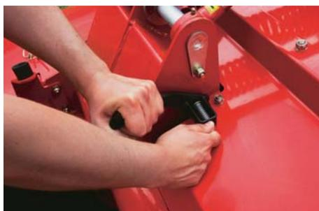
Пластина может быть установлена в трех положениях, в соответствии с необходимой степенью плющения.
