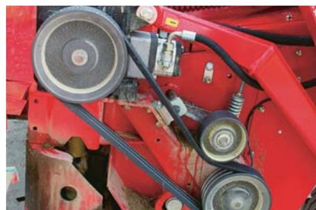
Привод плющильного аппарата осуществляется с помощью 3 V-ремней, обеспечивающих плавную и бесшумную передачу мощности на ротор.
