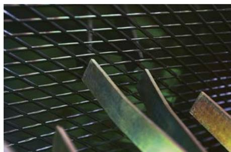
Рёбристая структура пластины плющильного аппарата усиливает эффект плющения, так как при трении о пластину разрушается структура листьев скошенной массы.
