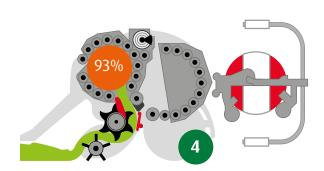
Обмотчик поднимается в рабочее положение и начинается процесс обмотки рулона.
