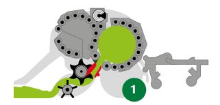
Рулон формируется в основной прессовальной камере до тех пор, пока не будет достигнута заданная оператором плотность.
