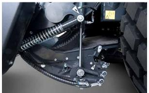
Система измельчения с 25-ю ножами, а также системой drop floor и возможностью выбора групп.
