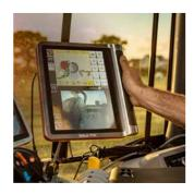
Камера заднего вида IsoMatch Eye в сочетании с универсальным терминалом Tellus Pro, позволяет оператору следить за выполнением обертывания и выгрузки рулонов.
