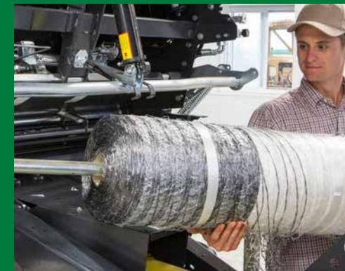
Очень низкая высота загрузки и очень простая заправка системы означают минимальное время простоя и максимальное использование времени для формирования рулонов.
