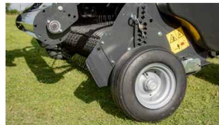
Колеса с высокой проходимостью и простой регулировкой высоты.
