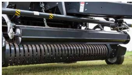
Большой диаметр пресс-ролика для повышенных скоростей работы.
