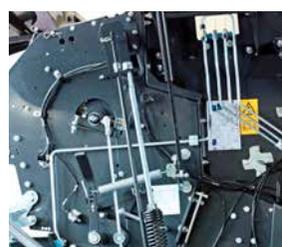
Жесткие стальные трубопроводы для гидравлических контуров.
