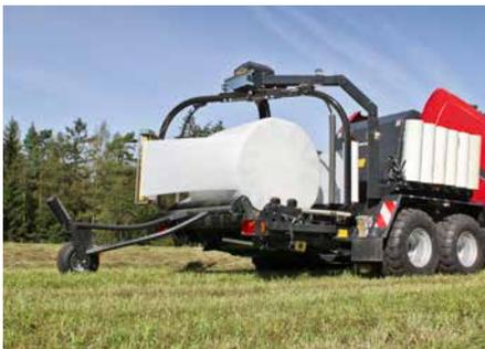
Двухрукавный обмотчик с 2 преднатяжителями и 4 бесконечными ремнями для быстрой и надежной обмотки.
