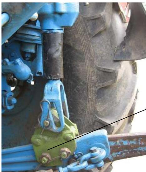
7.1.4 При агрегатировании косилки КДН-2,7 с тракторами тягового класса 1,4 установите минимальную длину раскосов навесной системы трактора и оборудуйте нижние тяги удлинителями 1 (КД 52.00.000) в соответствии с рисунком 11.
