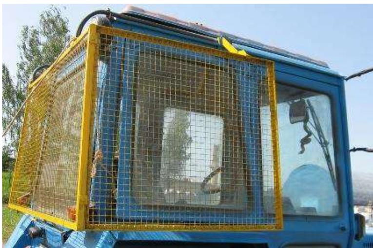
Рисунок 15-Вид на защитное сетчатое ограждение
