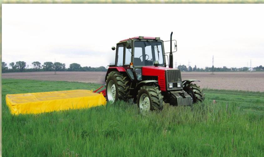
Небольшая масса косилки позволяет значительно уменьшить давление на почву и лучше копировать все её неровности, обеспечивая ровную высоту среза по всей ширине захвата, что гарантирует отличные результаты работы, как на больших ровных полях, так и на маленьких участках со сложным рельефом.
