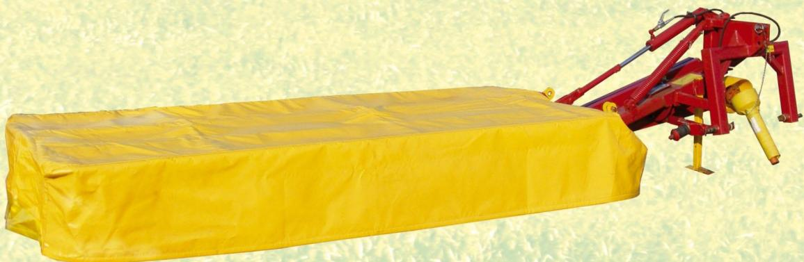
Косилка предназначена для кошения зеленых сеяных и естественных трав с укладкой скошенной массы на стерню в валок. Косилка агрегатируется с тракторами тягового класса 1,4 (МТЗ-80/82 и др.).
